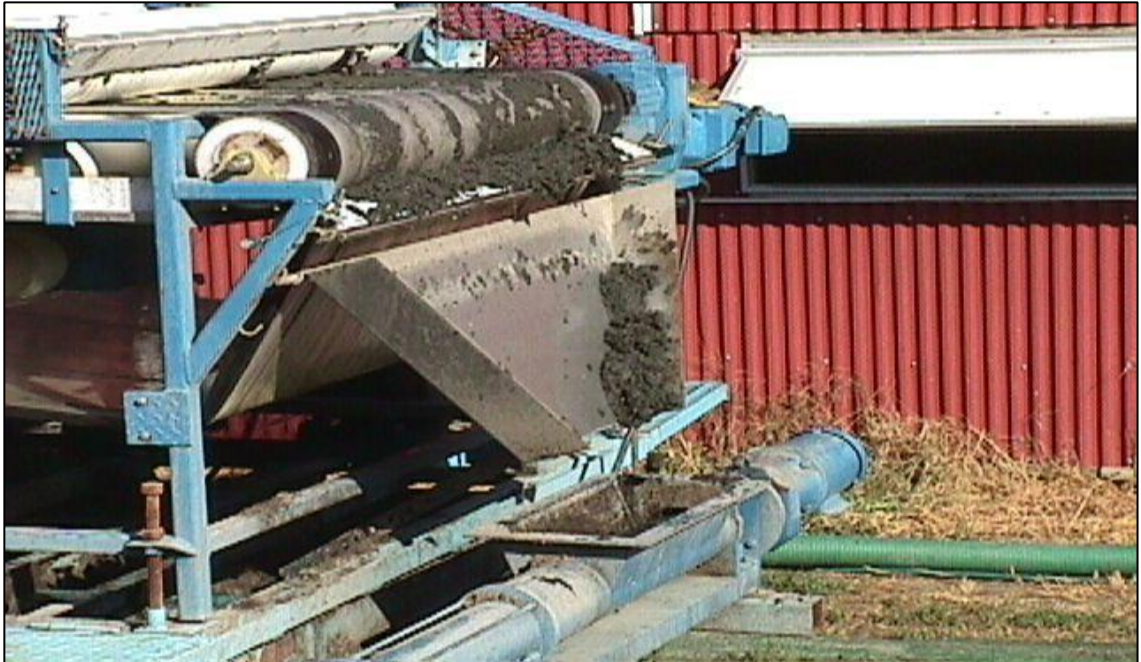
صور رقم 9 توضح ماكينة تجفيف الحمأة باستخدام سيور الترشيح الضاغطة
