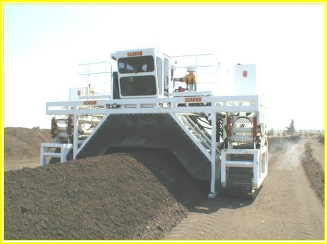
صور رقم . توضح شكل مصفوفة الحمأة وعمليات التقلب الميكانيكي
